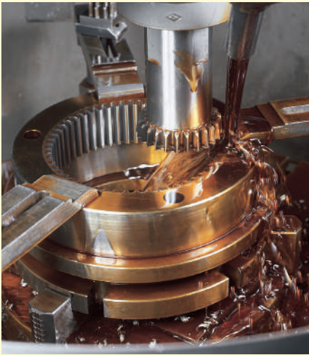
使用 CNC 插齿机加工内齿轮轮齿
