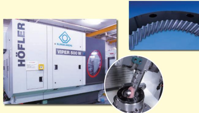
KLINGELNBERG 公司制造的齿轮磨削床 VIPER500W
