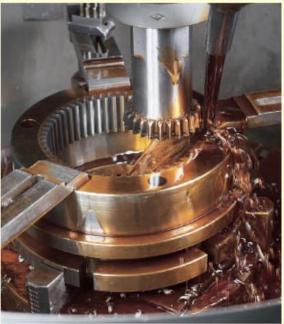
使用 CNC 插齿机加工内齿轮轮齿
