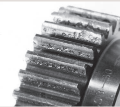
由于齿面强度不足而造成的磨损例
