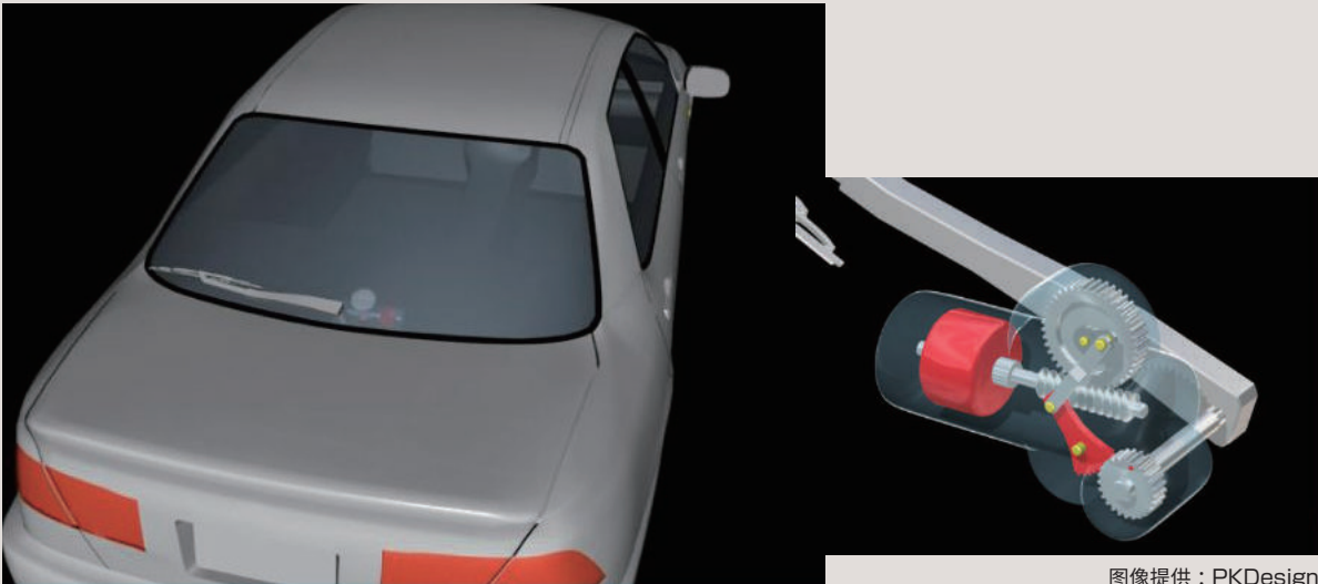
用于雨刷摆动机构的蜗轮蜗杆
