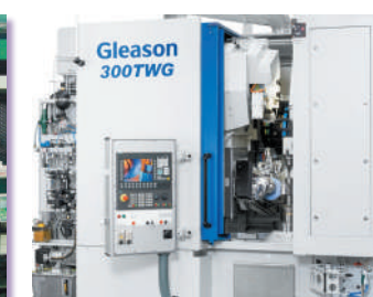
CNC 齿轮磨削床 (300TWG)
