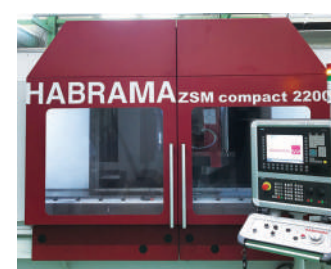
齿条磨削床 (ZSMcompact2200)
