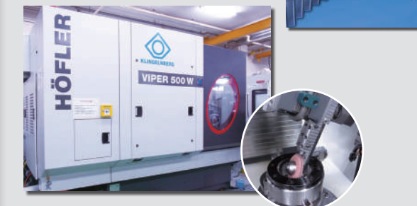
KLINGELNBERG 公司制造的齿轮磨削床 VIPER500W
