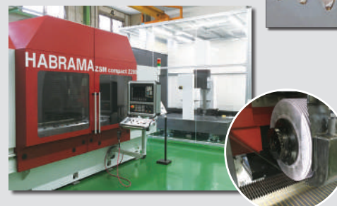
德国 HABRAMA 公司制造的齿轮磨削床 ZSMcompact2200
