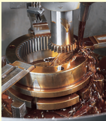
使用 CNC 插齿机加工内齿轮轮齿
