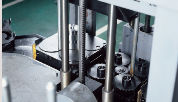
工件存放装置 ( 放置台上下移动 ) 使用了 SRO 圆形齿条
