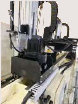
汽车零部件的自动搬送清洗装置使用的 SRCPF-H 齿条和 SSCP 直齿轮
