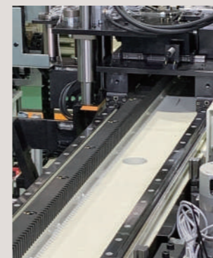
用于恒速驱动焊枪的 SRCPFD 齿条和 SSCP 直齿轮、用于工件定位的 SRO 圆形齿条和 SS 直齿轮
