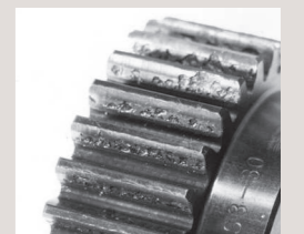
由于齿面强度不足而造成的磨损例
