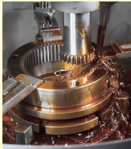
使用 CNC 插齿机加工内齿轮轮齿
