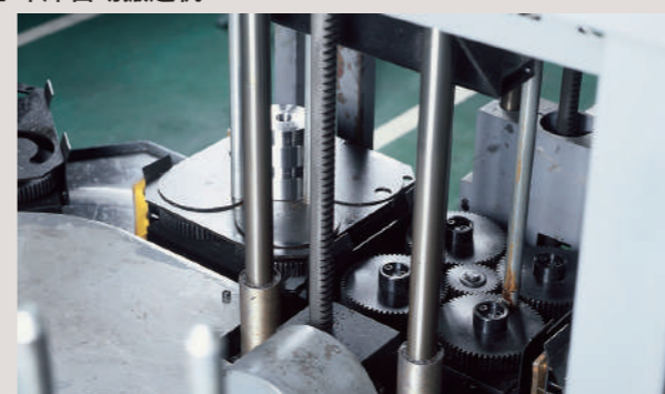
工件存放装置 (放置台上下移动) 使用了 SRO 圆形齿条
