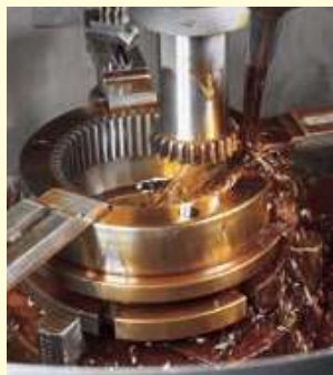
使用 CNC 插齿机加工内齿轮轮齿
