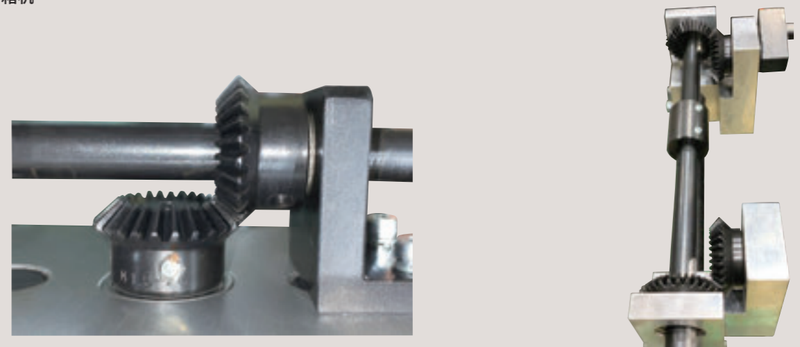
用于 XY 轴驱动、机械动力传递的 SM、SMB 等径锥齿轮
