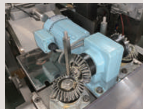
鱼的开三片处理所用的 SMB 等径锥齿轮
