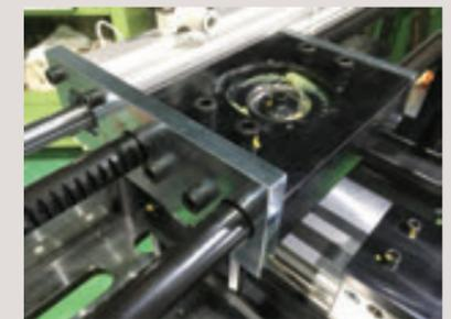
用于恒速驱动焊枪的 SRCPFD 齿条和 SSCP 直齿轮、用于工件定位的 SRO 圆形齿条和 SS 直齿轮
