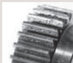
由于齿面强度不足而造成的磨损例
