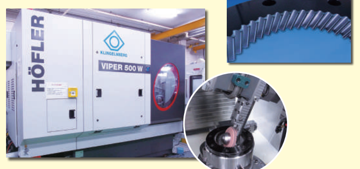
KLINGELNBERG 公司制造的齿轮磨削床 VIPER500W
