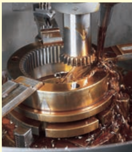
使用 CNC 插齿机加工内齿轮轮齿
