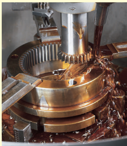
使用 CNC 插齿机加工内齿轮轮齿
