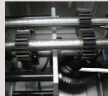
用于搅拌装置的 SSA、SS 直齿轮
