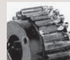
由于弯曲强度不足而造成的损坏例
