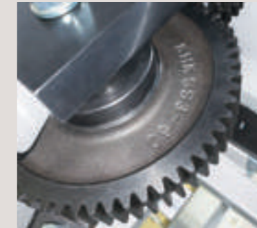
自动制箱机所用的 SS 直齿轮
