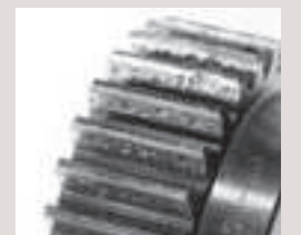
由于齿面强度不足而造成的磨损例
