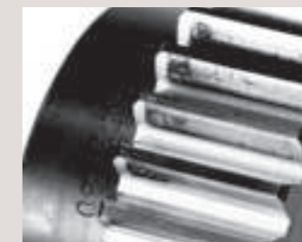
轮齿的片端接触及点蚀
