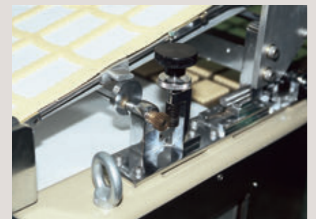
使用 SW 蜗杆和 BG 蜗轮调整高度
