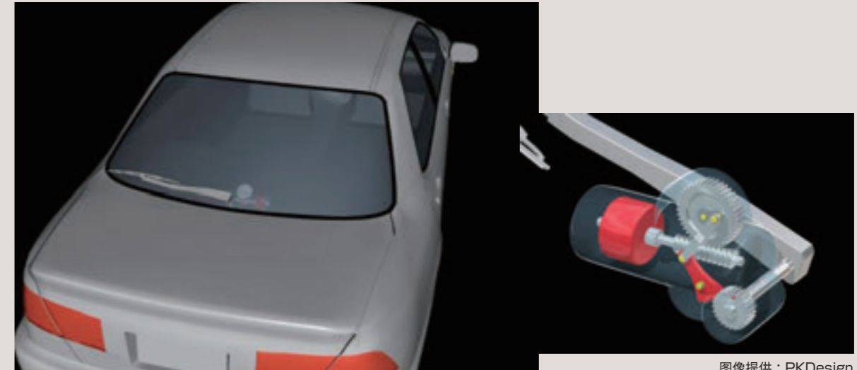
用于雨刷摆动机构的蜗轮蜗杆
