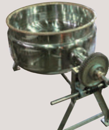
使用 SW 蜗杆和 CG 蜗轮带动大锅旋转
